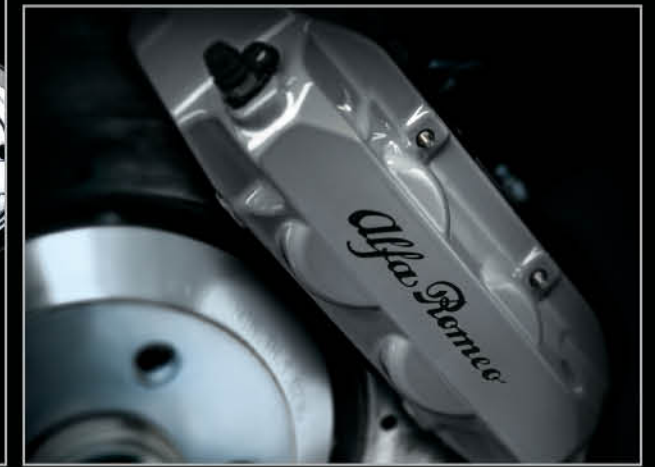
305x28 mm hava soğutmalı Brembo ön fren diskleri
