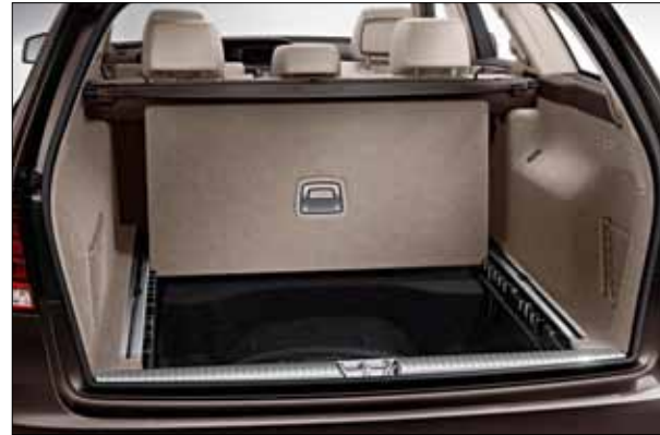
EASY-PACK katlanabilir yükleme zemini, kademeli bir şekilde açılmayı sağlar.
