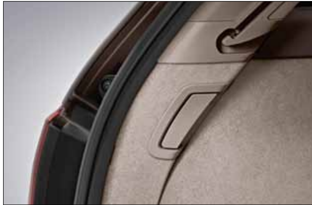
Arka koltuk sırt dayanaklarının rahat bir şekilde katlanabilmesi için kilit açma tutamağı.
