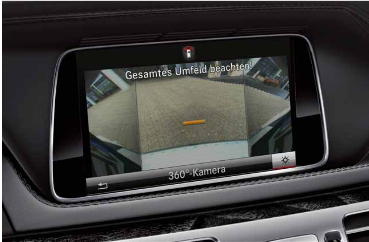
360° kamera sistemi dört kamera yardımıyla aracın çevresini görüntüleyebilir.
