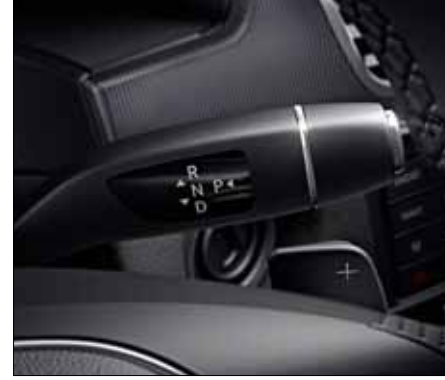
DIRECT SELECT vites seçme kolu (7G-TRONIC PLUS ve 9G-TRONIC ile bağlantılı olarak).
